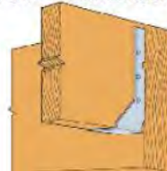
SOPORTE DE VIGA ALA INTERNA
